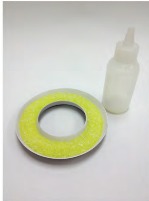
Pour the frit evenly into the mold.
